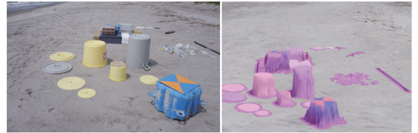
図6 模擬ごみをつかった実験の様子 海岸に配置した模擬プラスチックごみをドローンで撮影した写真(左)からAIがプラスチックだけを赤色に着色して示した(右)。プラスチックの多様な形状を的確に見分けて特定する。体積は立体に再構成した時の底面積と高さの推測値から、算出する。(出典:Kako et al., 2020, Marine Pollution Bulletin, 155, 111127)
